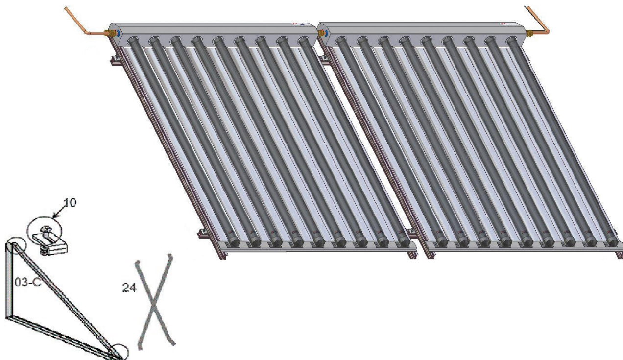
Obr. 15: Trojúhelníková podpěra a zavětrovací kříž
