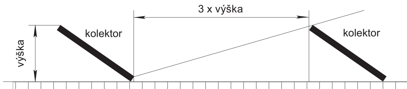
Obr. 23: Minimální vzdálenost kolektorových polí
