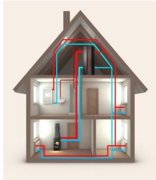
Obr. : Zapojení krbových kamen s teplovodním výměníkem v rodinném domě
