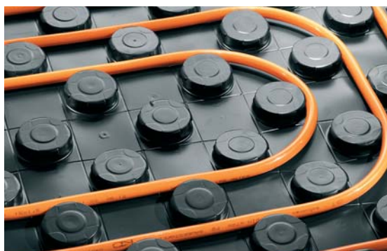
5a. Minimální poloměr oblouku je zabezpečen ohybem okolo 3 výstupků při ohybu o 180°, příp. okolo 2 výstupků při ohybu o 90°.
